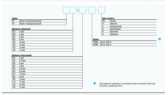
Пример заказа: Полиуретановый шланг, наружный диаметр 4 мм, внутренний диаметр 2,5 мм, синий.
